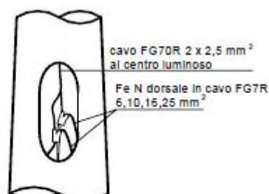
Fig. 2c - DERIVAZIONE AL CENTRO LUMINOSO REALIZZATA ALL'INTERNO DEL SOSTEGNO
